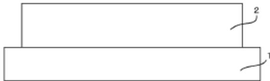
シリコンの基板 1 上に P Z T 膜を C V D 法により形成した後、フォトリソグラフィ法によりパターンニングし、所定の大きさに加工
