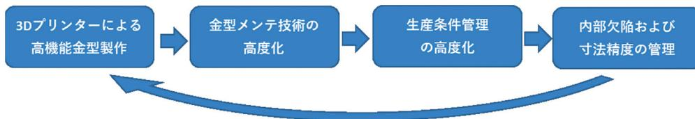
これらの設備を導入し、温度センサーを活用することで、過去のノウハウと標準化したデータから、金型温度の変化に対し、タイムリーかつ予測しながら対応できる仕組みを構築します。さらに、X線CTなどを活用した評価データのフィードバックをシステム化することで、加工時間の大幅削減ができる生産システムを構築していきます。これらの取組により、技術の国内回帰や、顧客への最適な形状提案、コスト提供の実現を目指します。
